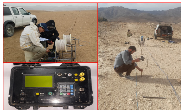
شکل ۴ - دستگاه ژئوالکتریک (پتانسیلومتر) Kgmeter 0.2 و متعلقات آن (الکترودهای فولادی و برنجی و سیم‌های جریان) برای برداشت‌های سونداژهای ژئوالکتریک و اندازه‌گیری مقاومت ویژه در منطقه
