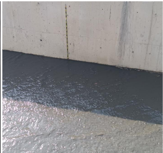
شکل ۶- اندازه‌گیری عمق رواناب حاصل از بارش در کانال‌های پردیس دانشگاه فردوسی مشهد
