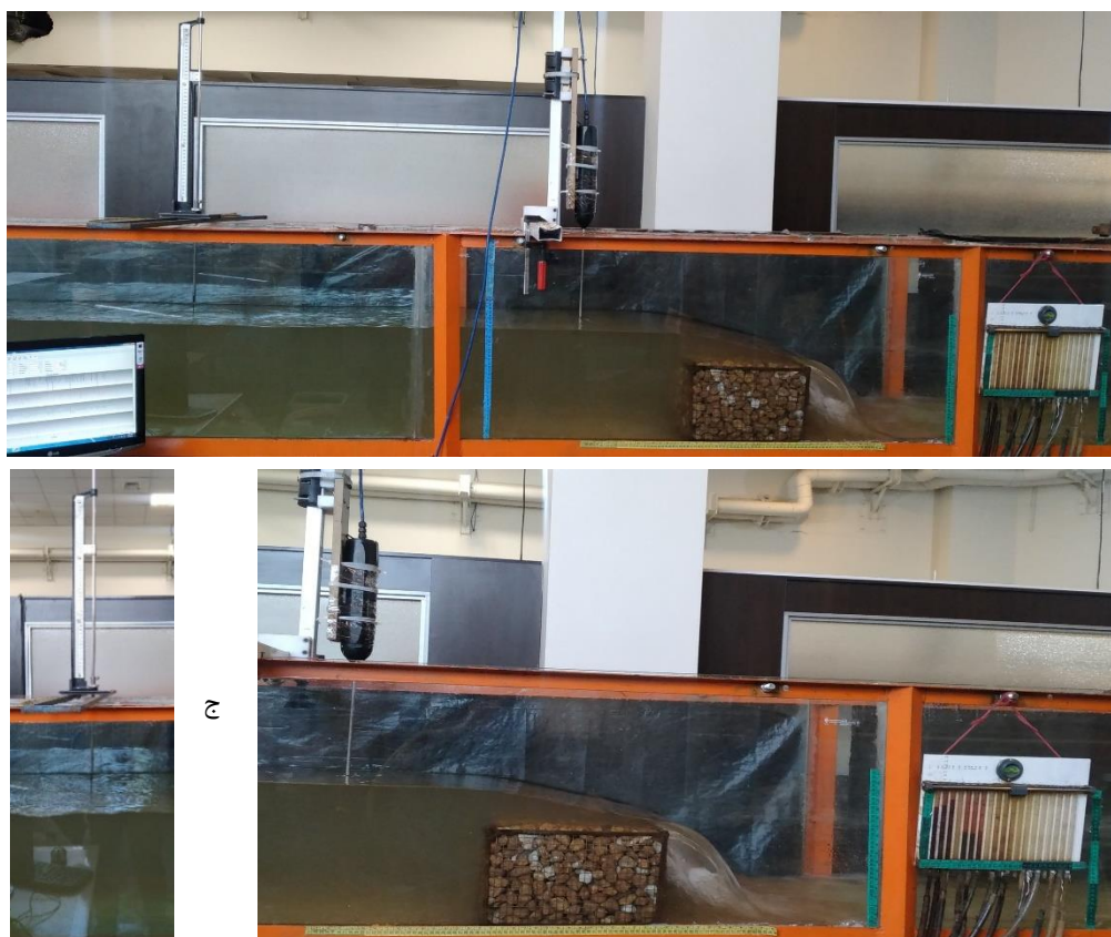
شکل ۱- الف) شمای کلی از سرریز گابیونی آزمایشگاهی و تمام تجهیزات مورد استفاده، ب) موقعیت دستگاه سرعت سنج ADV و مانومترهای اندازه گیری، ج) عمق سنج مکانیکی
