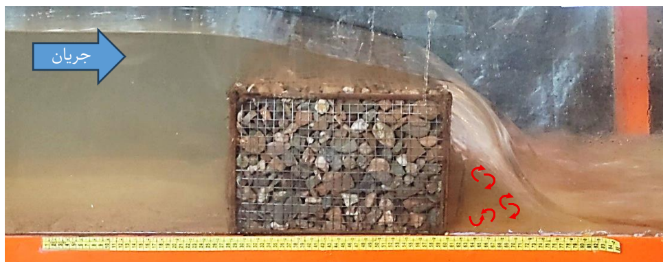
شکل ۶- تشکیل جریان آشفته و چرخشی در پایین دست سرریز
