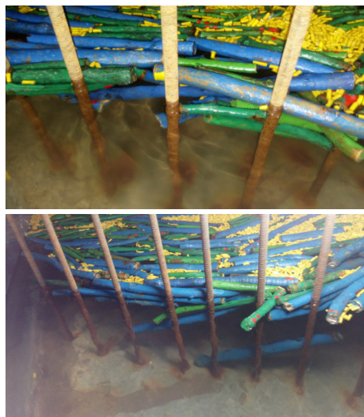
شکل ۱۰- ارتفاع کپه‌ی واریزه‌ای ایجاد شده در وسط سازه آشغال‌گیر در آزمایشگاه
