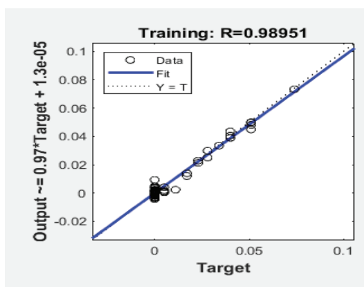
شکل ۷- مقایسه ضرایب نشت مدل‌سازی شده با خروجی شبکه عصبی و تعیین ضریب رگرسیون
