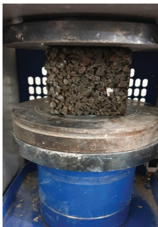
شکل ۴- تست مربوط به آزمایش مقاومت فشاری
