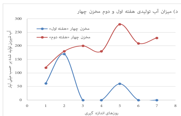
شکل ۴- میزان آب تولید شده در شرایط وجود جاذب پلی‌اتیلن «هفته اول» و شیشه رنگ شده کف مخزن «هفته دوم»؛ (الف)، مخزن شماره یک؛ (ب)، مخزن شماره دو؛ (ج)، مخزن شماره سه؛ (د)، مخزن شماره چهار
