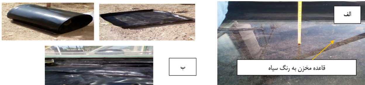
شکل ۳- نمایی از جاذب‌های استفاده شده (الف) استفاده از رنگ سیاه؛ (ب) استفاده از جاذب پلی‌اتیلن
