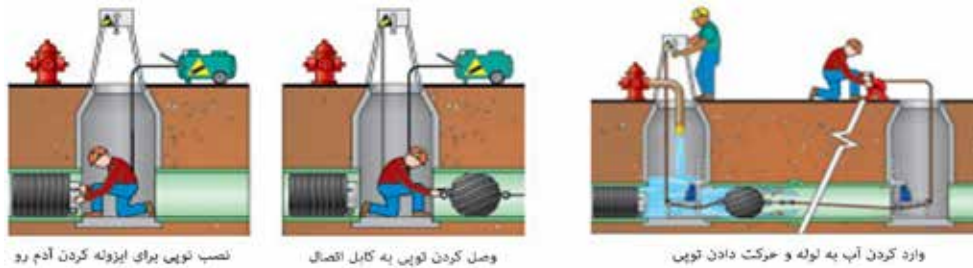
شکل ۵- طرح‌واره روش توپی برای شست‌وشوی خطوط فاضلاب
