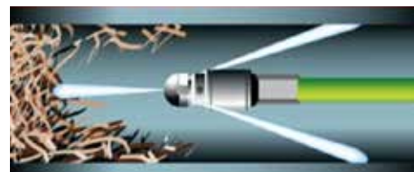
شکل ۴- طرح‌واره روش شست‌وشوی پرسرعت برای شست‌وشوی خطوط فاضلاب
