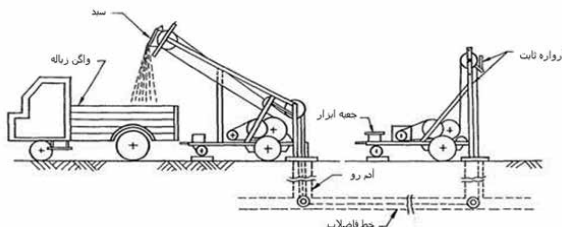
شکل ۲- طرح‌واره ماشین باکت (سطل‌کش) برای شست‌وشوی خطوط فاضلاب
