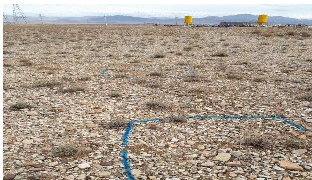
شکل ۱- مشخص کردن محل حفر گودال با رنگ به‌منظور قراردادن تشت‌های تبخیر کلرادو
