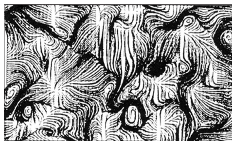
شکل ۱۱- DNS جریان‌های لحظه‌ای در سطح جریان کانال‌های باز (Banerjee و Pan، ۱۹۹۵)
