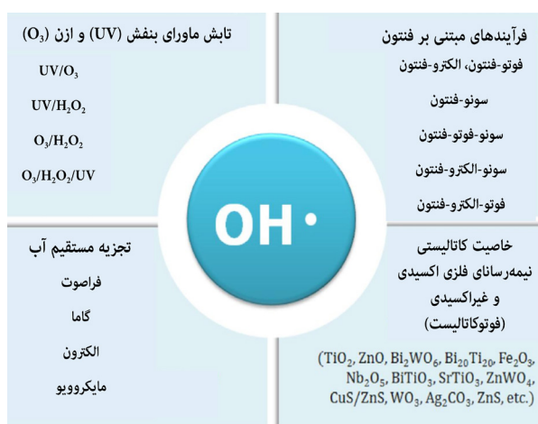
شکل ۱- طبقه‌بندی فرآیندهای اکسایش پیشرفته برای تصفیه آب و فاضلاب با توجه به روش تولید رادیکال هیدروکسیل (Lee و Park، ۲۰۱۳)
