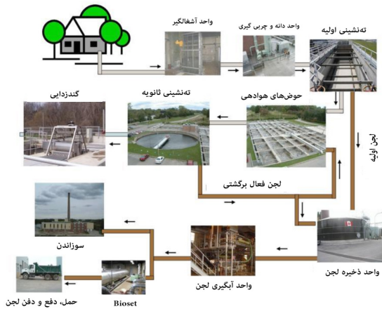
شکل ۶- تصویر شماتیک طرح کلی واحدهای سیستم لجن فعال برای تصفیه فاضلاب ( https://www.sswm.info )
