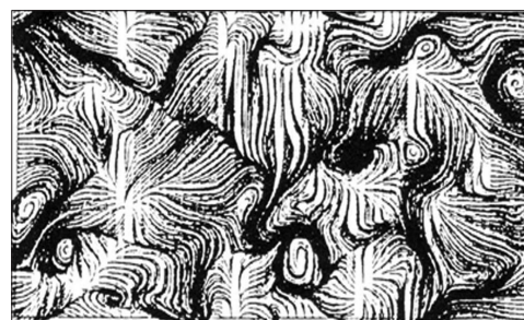
شکل ۱۱- DNS جریان‌های لحظه‌ای در سطح جریان کانال‌های باز (Pan و Banerjee، ۱۹۹۵)
