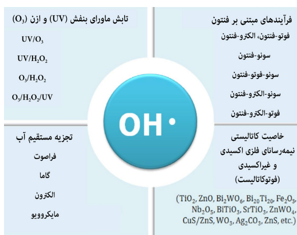
شکل ۱- طبقه‌بندی فرآیندهای اکسایش پیشرفته برای تصفیه آب و فاضلاب با توجه به روش تولید رادیکال هیدروکسیل (Park و Lee، ۲۰۱۳)
