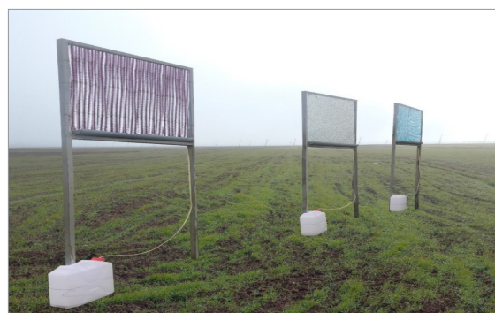
شکل ۲- جمع کننده‌های مه نصب شده در منطقه آبی بیگلو
