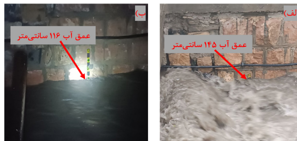
شکل ۴- نمونه‌ای از اندازه‌گیری‌های عمق آب در مسیل چهارچشمه الف) بارش ۱۴۰۳/۲/۲۹ ب) بارش ۱۴۰۳/۲/۱۹
